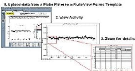
Puede revisar y comparar de manera instantánea datos de hasta 6 medidores diferentes en el mismo documento, lo que ofrece capacidades de análisis que un solo medidor no puede proporcionar.
