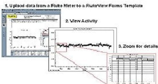
Los profesionales pueden revisar y comparar datos instantáneamente de hasta 6 multímetros diferentes en el mismo documento, lo que ofrece posibilidades de análisis que un multímetro por sí solo no puede proporcionar.
